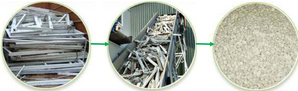
*Слика 4.6. Добијање гранулата од ПВЦ прозора*
