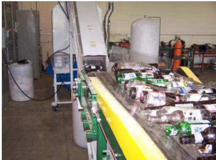
*Слика 4.7. Постројење за рециклажу стакла*
