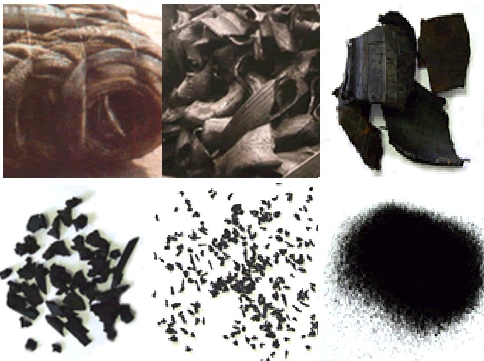
Слика 4.11. Уситњавање аутомобилских гума до најмање гранулације
